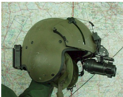
BIV-Brille montiert an Pilotenhelm, Bauteile und Beispielbild
