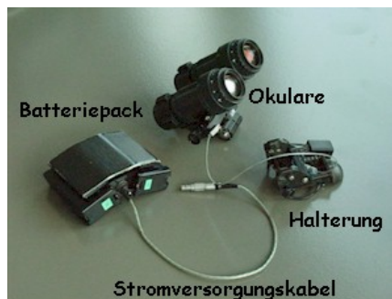
BIV-Brille montiert an Pilotenhelm, Bauteile und Beispielbild
